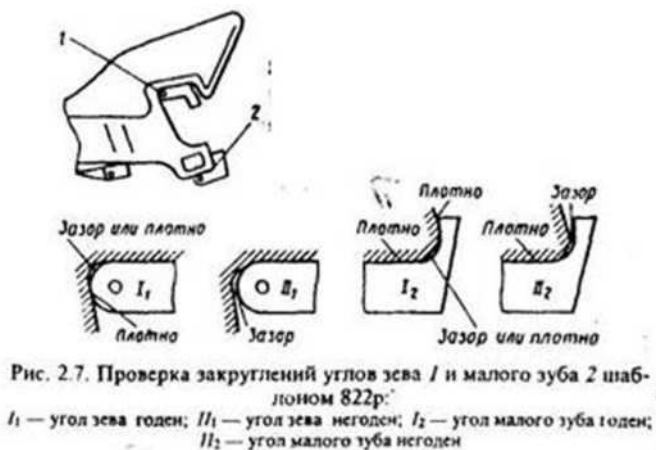
Рисунок 2.7 - Проверка закруглений углов зева 1 и малого зуба 2 шаблоном 822р: I 1 - угол зева годен, II 1 - угол зева негоден; I 2 - угол малого зуба годен; II 2 - угол малого зуба негоден
