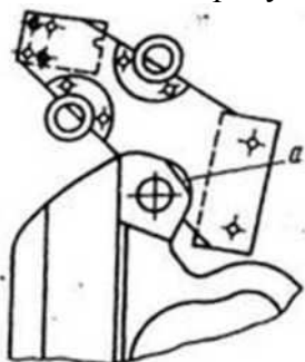
Рис. 2.26. Проверка износа прилива для шипа шаблоном 833р
